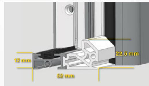
Die Schwelle an der Innenseite 12 mm und an der Außenseite 22,5 mm hoch.
